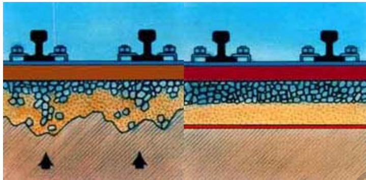
**Филтър при полагането на дренажни тръби.** При дренирането на авто и ЖП пътища, хвостохранилища, сметища, жилищни и стопански постройки геотекстилите отвеждат чрез порите на материала, водата или газовете във вертикално или хоризонтално направление, като задържат камъчетата и останалите замърсители. Те са практически заместители на хоризонтални или вертикални дренажни слоеве изпълнени с инертни фракции.
